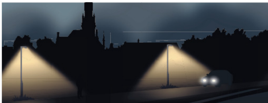
Dålig belysning: För långt mellanrum mellan stolparna ger en flackare ljusbild som blir starkt bländande samtidigt som vägen blir mycket ojämnt belyst.
