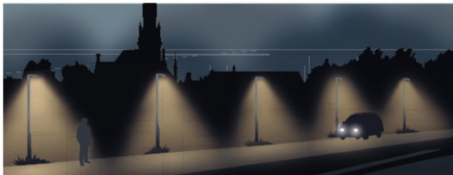
God belysning: Vid projektering av trafikbelysning måste man ta hänsyn till ljusets kvalitet och egenskaper, så att ljuset får en god och jämn spridning på vägen utan att blända samt att belysningsnivån blir tillräcklig.
